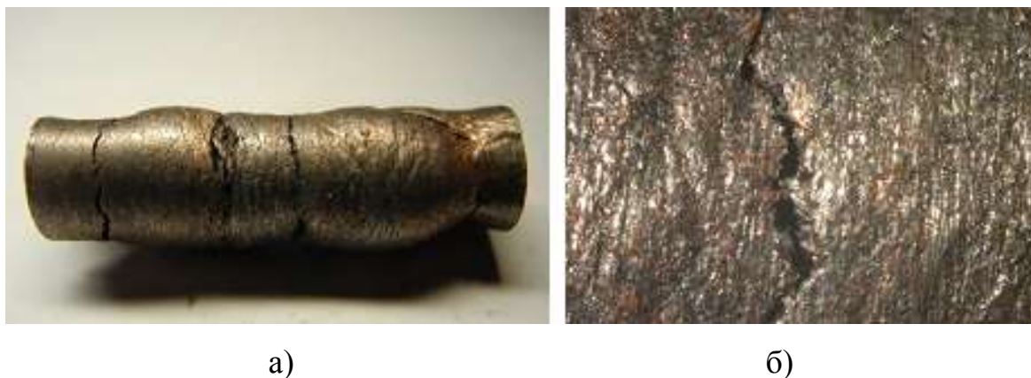
Рис.4.41. Загальний вигляд тріщини при стисненні збірного зразку «мідь М1 – чавун СЧ20»: а) – загальний вигляд зразку; б) – вигляд утвореної тріщини
