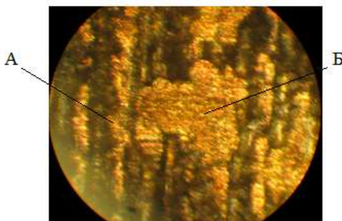
Рис.6.10. Фрагмент ( \times 140 ) основи із покриттям: А – покриття у міжгребінцевій западині; Б – покриття у вигляді пластівчастої плями
