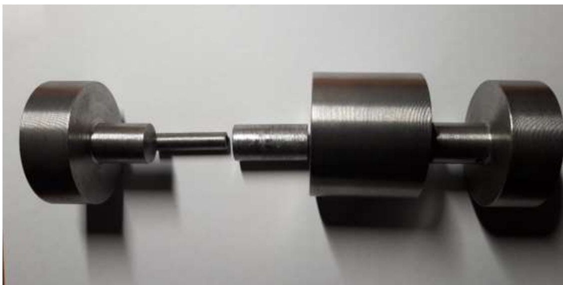
Рис.4.31. Загальний вигляд пристрою при проведенні експериментів з стиснення збірного зразка «чавун – свинець»
