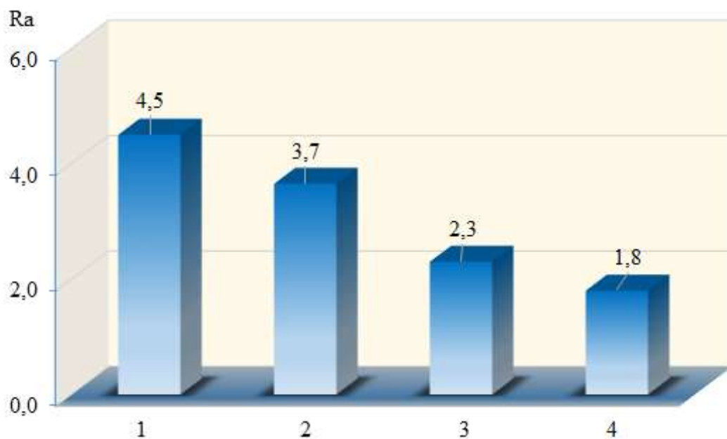
Рис.6.20. Зміна параметру R_a при обробці втулки №2 з використанням операцій: 1 – розточування; 2 – ФАБО; 3 – ДПР з одним деформуючим елементом; 4 – ДПР з двома деформуючими елементами
