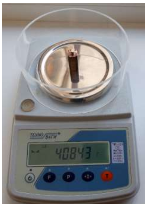
Рис.2.33. Зважування латунного інструменту на лабораторних вагах ТВЕ-0,21-0,001
