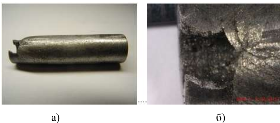
Рис.4.33. Руйнування збірного зразка «чавун – свинець»: а) – зовнішній вигляд чавунного зразка; б) – ділянка зразка з руйнуванням
