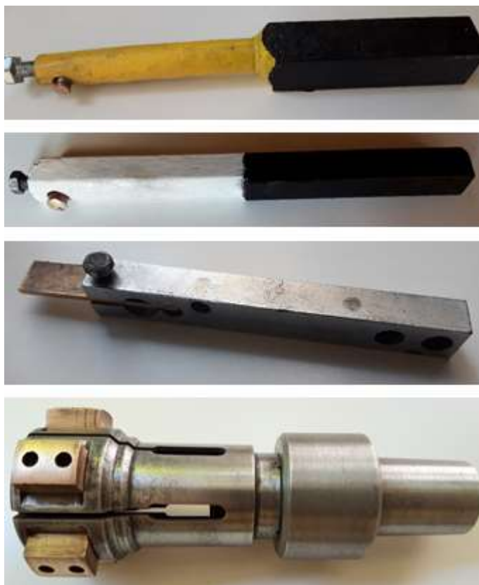
Рис.2.10. Конструкція інструментів для фрикційно-механічного нанесення антифрикційного покриття
