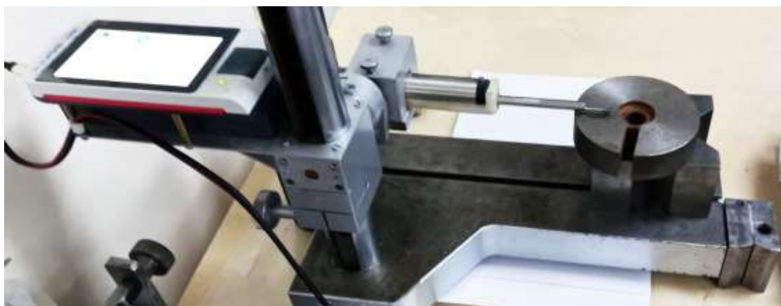
Рис.2.35. Вимірювання шорсткості поверхні дослідних зразків з використанням профілографа Mahr XR20
