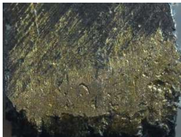
Рис.3.16. Наліпання латуні на задній поверхні різця із чавуну СЧ20 при натиранні латуні Л63 при передньому куті різання \gamma : а) \gamma = +5^\circ ; б) \gamma = 0^\circ ; в) \gamma = -15^\circ , \times 30
