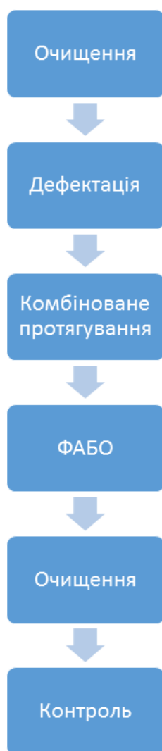
Рис.8.13. Структурна схема технологічного процесу відновлення гільз циліндрів ДВЗ в I ремонтний розмір
