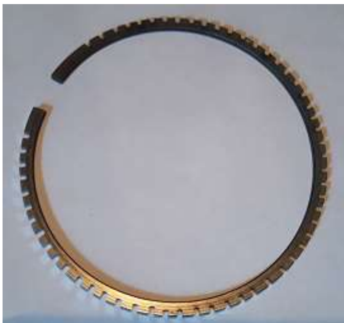
Рис.7.34. Загальний вигляд контртіла (розрізного кільця) при проведенні дослідження зношування пари тертя «гільза – кільце»
