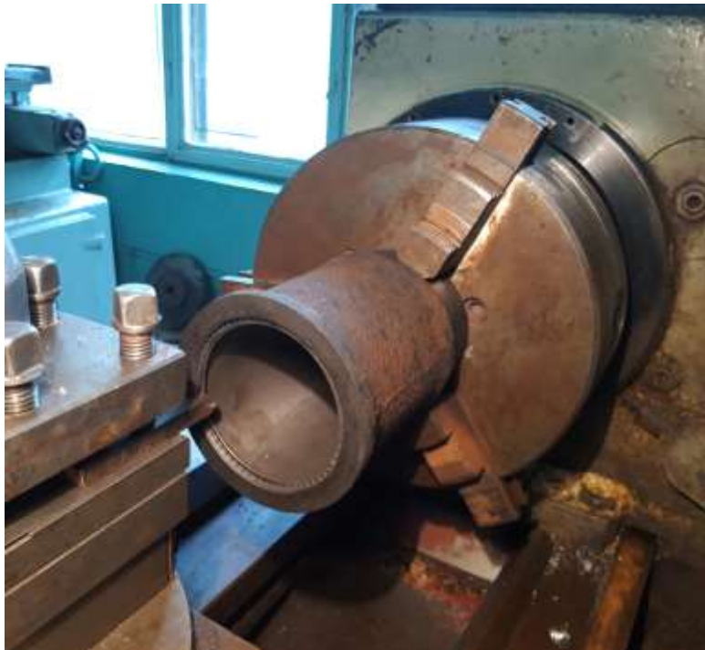
Рис.7.35. Робоча зона установки для дослідження зношування пари тертя «гільза – кільце»
