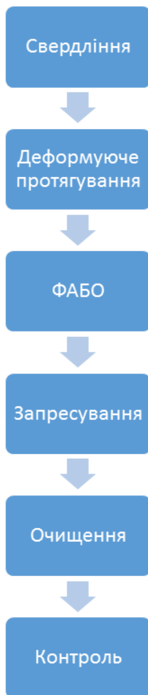
Рис.8.29. Структурна схема технологічного процесу збирання робочих вінців шарошечних доліт
