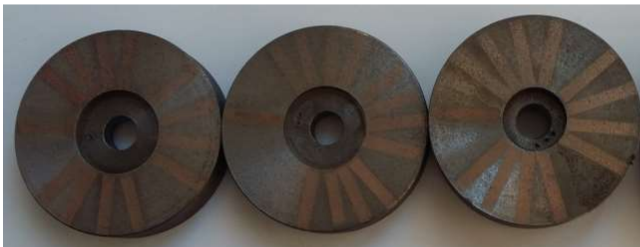
Рис.2.34. Досліджувані зразки з антифрикційним покриттям, нанесеним фрикційно-механічним методом
