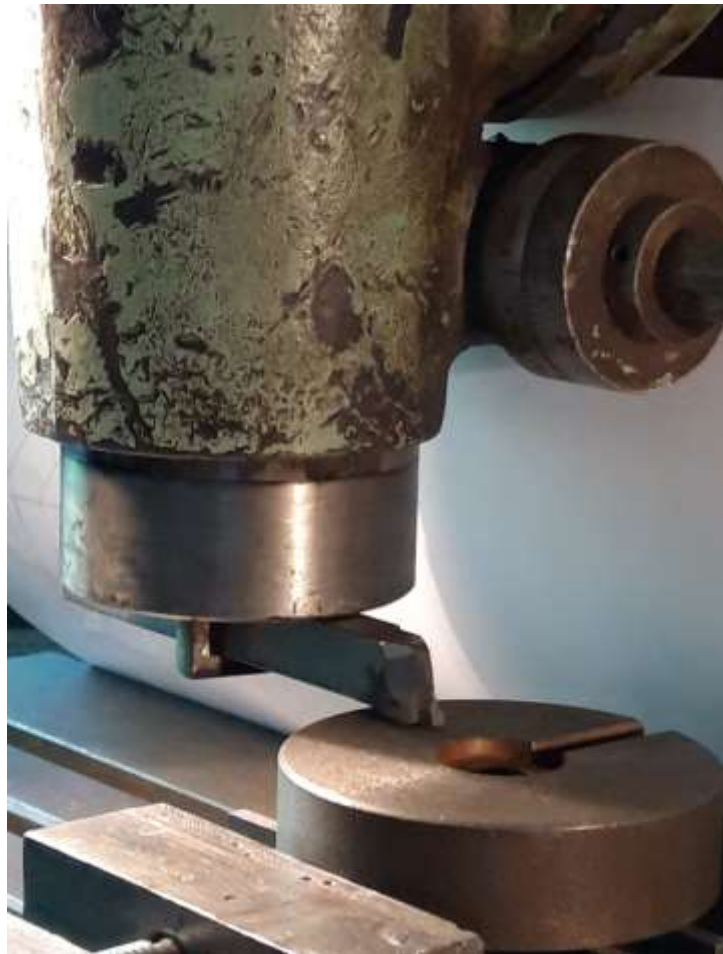
Рис.2.14. Робоча зона верстата при виконанні операції ХПД
