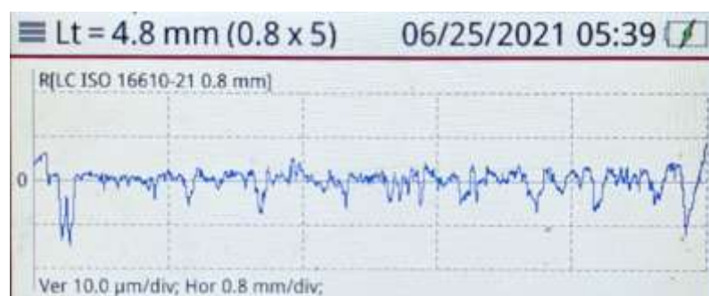
Рис.6.18. Мікрорельєф обробленої поверхні втулки 2 з розмірами d_0 = 35,1 мм; t_0 = 10,0 мм після операцій: а) розточування; б) ФАБО; в) ДПР з натягом a = 0,1 при куті нахилу твірної робочого конуса \alpha = 4^\circ ; г) другий цикл протягування \Sigma a = 0,2
