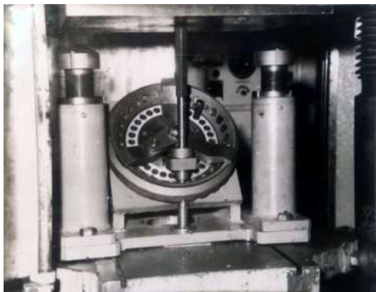
Рис.8.26. Запресовування твердосплавних вставок у вінці шарошок ВТ23
