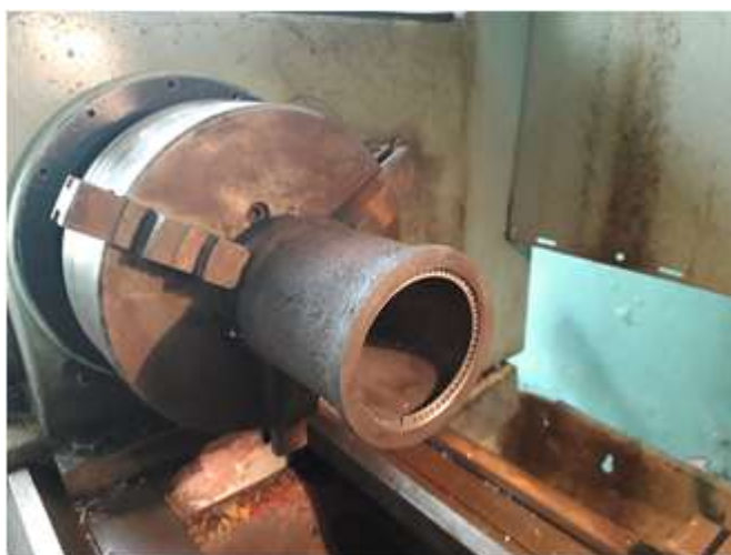
Рис.7.33. Загальний вид установки для дослідження зношування пари тертя «гільза – кільце»
