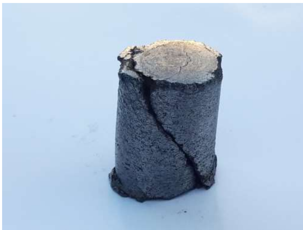
Рис.4.27. Загальний вигляд зруйнованого зразка із чавуну СЧ20 при проведенні випробувань на стиснення
