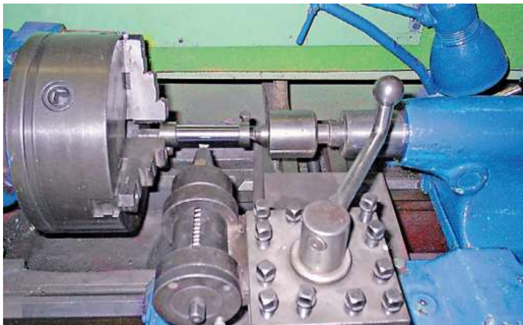
Рис.1.7. Пристрій для ФАБО деталей на токарному верстаті [90]
