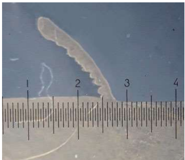
Рис.3.6. Коріння мікростружки, отримані при обробці мікрорізцем при різних передніх кутах різання \gamma : а) -\gamma = +5^\circ ; б) -\gamma = 0^\circ ; в) -\gamma = -5^\circ , збільшення \times 50
