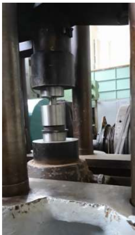
Рис.4.32. Робоча зона пристрою для стиснення досліджуваних зразків
