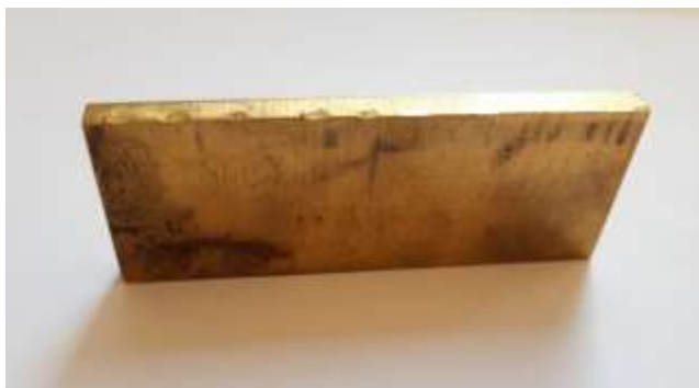
Рис.2.17. Загальний вигляд пластини із латуні Л63, що моделює дію антифрикційного інструменту при взаємодії з мікронерівностями
