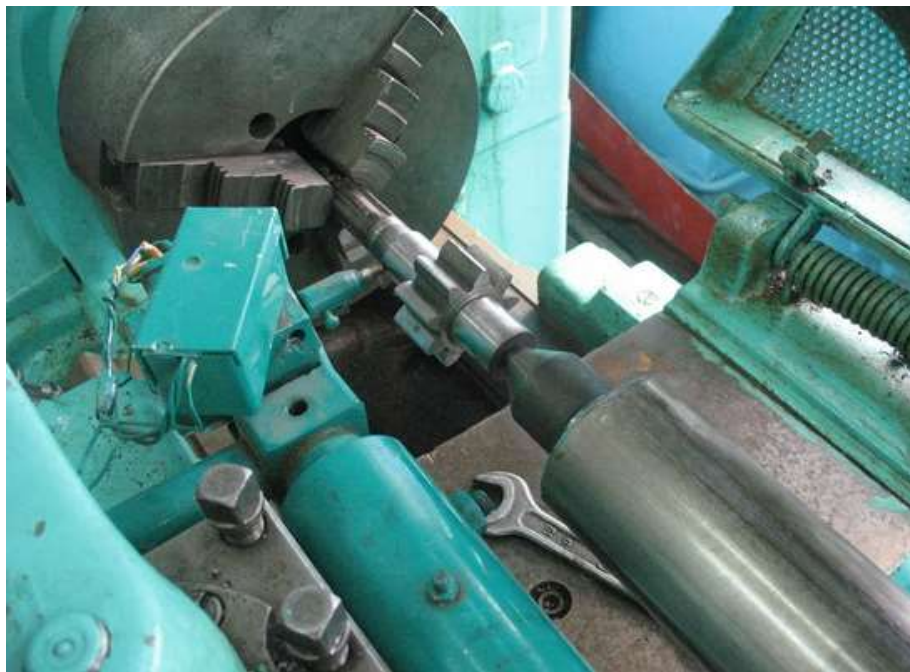
Рис.8.30. Робоча зона ФАБВО цапф шестерень гідронасосів
