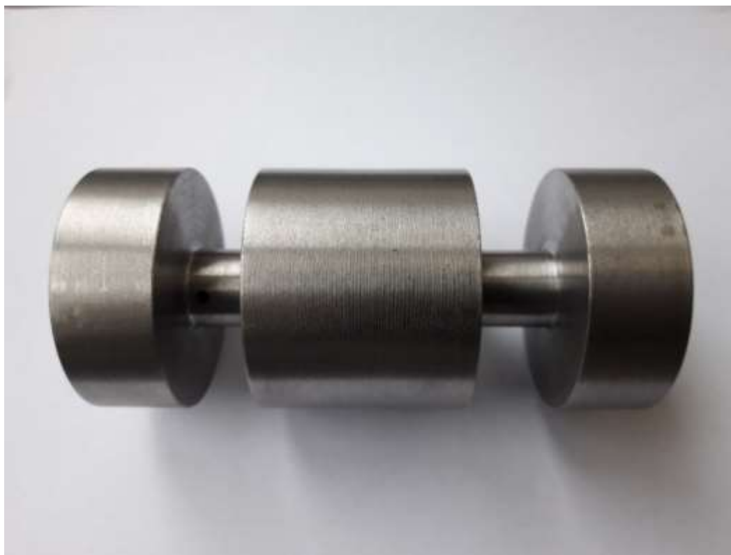
Рис.4.29. Пристрій для стиснення зразків: а) – схема пристрою; б) – загальний вигляд
