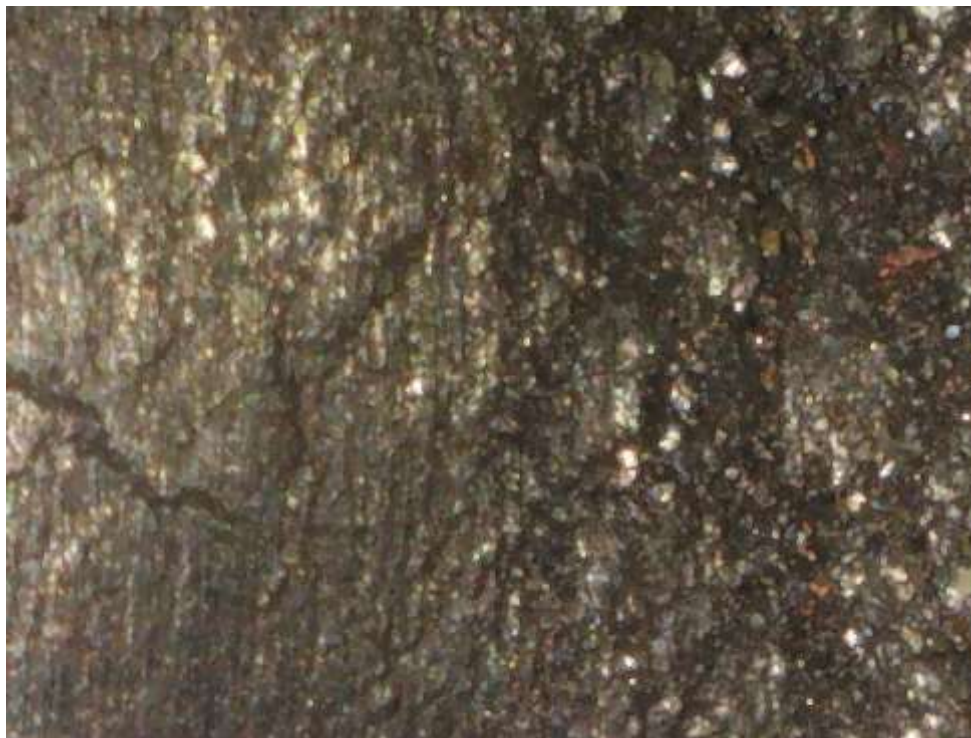
Рис.4.38. Загальний вигляд тріщини чавунного зразка
